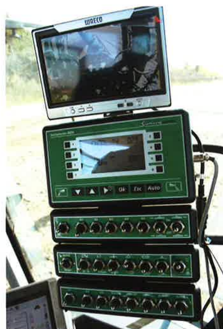
SlurryMaster 6000 er for nybegyndere en lidt mere indviklet affære. Man får ikke vist nogle steder hvilke knapper, man skal taste på for at komme ind i de forskellige menuer. Til gengæld har den masser af funktioner for den professionelle bruger. Computeren har dog et ”kvik setup” for de mest nødvendige funktioner.
