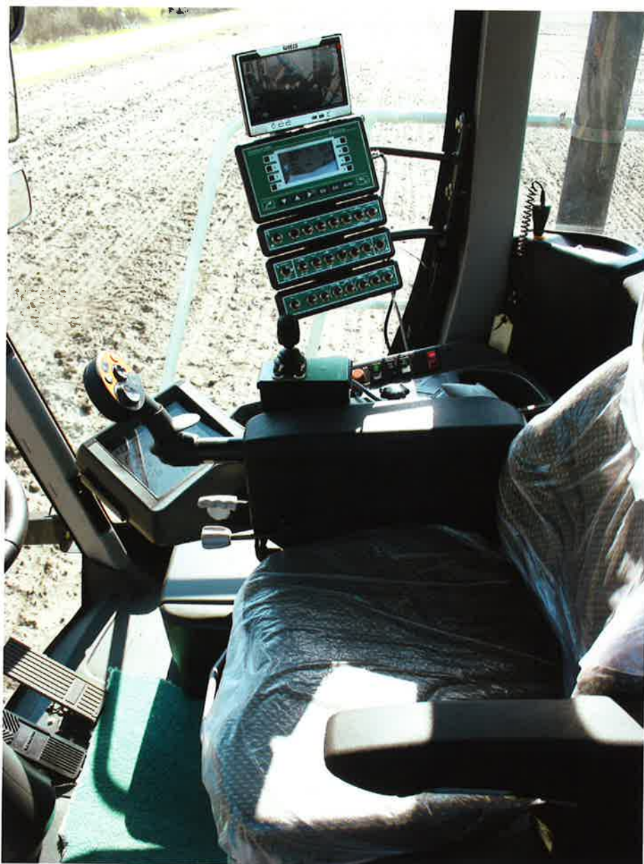
Samson-vognen og Claas-traktoren er to separate enheder. Det kan ses i kabinen, hvor computeren fra gyllevognen er monteret på en bæjle i stedet for at være integreret i traktorens elektronik. Til gengæld kan traktoren spændes fra vognen og bruges til andre opgaver end gylletjansen.
