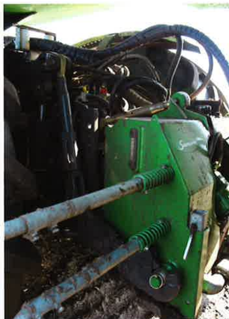
Hydrauliktanken er monteret i traktorens lift. Pto'en driver en oliepumpe, som leverer olie til læsse- og aflæsepumpen.
