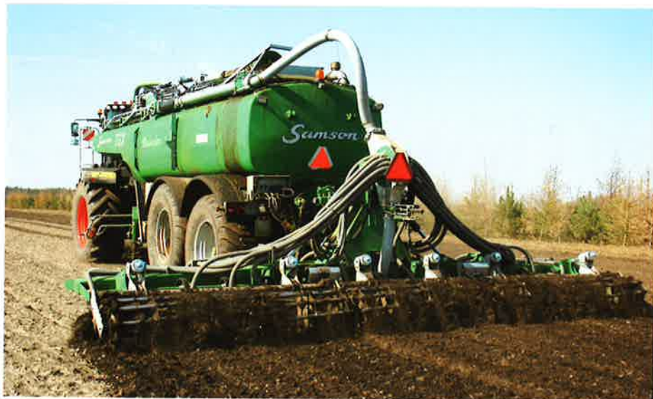
Claas Xerion kan også køre i krabbestyring. Når det sker, læses hjulstyringen på vognen op, så den løber lige bagefter traktoren. Hjulstyringen skal imidlertid låses op via en menu i SlurryMaster-computeren.
