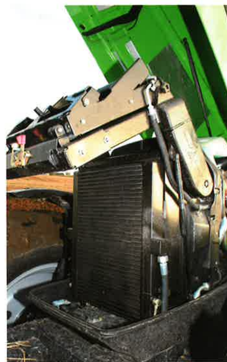
Først lukkes køleren til aircondition og inter-cooler op.
