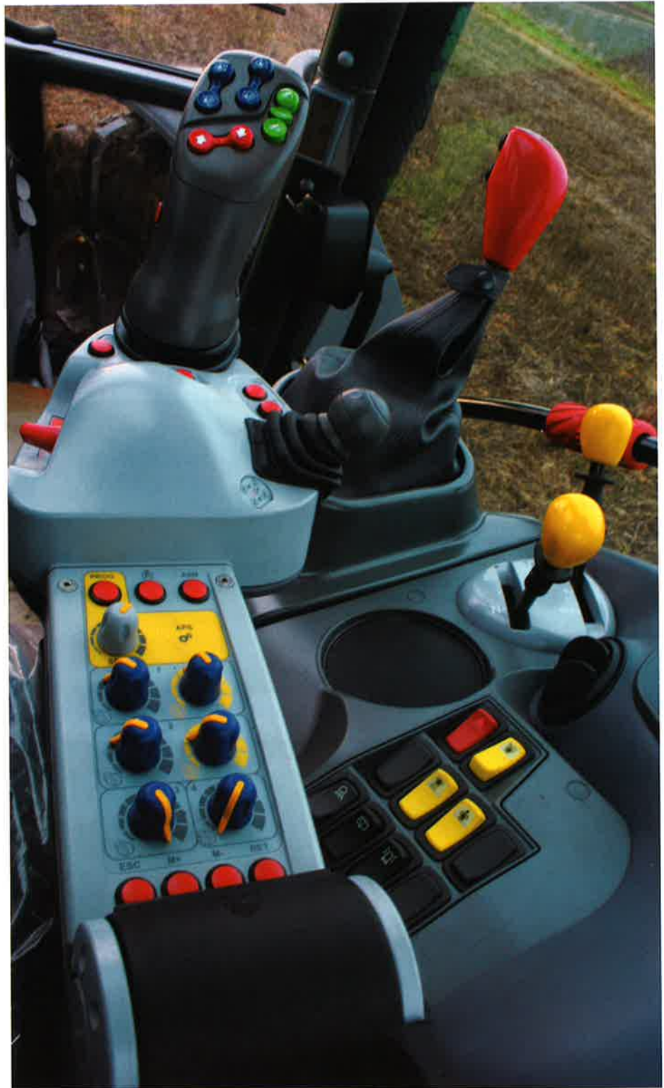
På drejknapperne i armlænet kan man styre olieflowet på de eksterne hydraulikventiler. Det er også muligt at styre to af ventilerne med timer. På joysticket sidder funktioner til at styre to olieudtag, vendegearet, liften og (forager-automatikken, mens man ved at vippe håndtaget frem eller tilbage skifter mellem de fire powershiftgear. Det lille joystick styrer de to resterende olieudtag.
