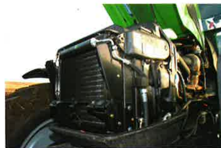
Køleren er konstrueret, så det er let at blæse den ren for skidt og snavs.
