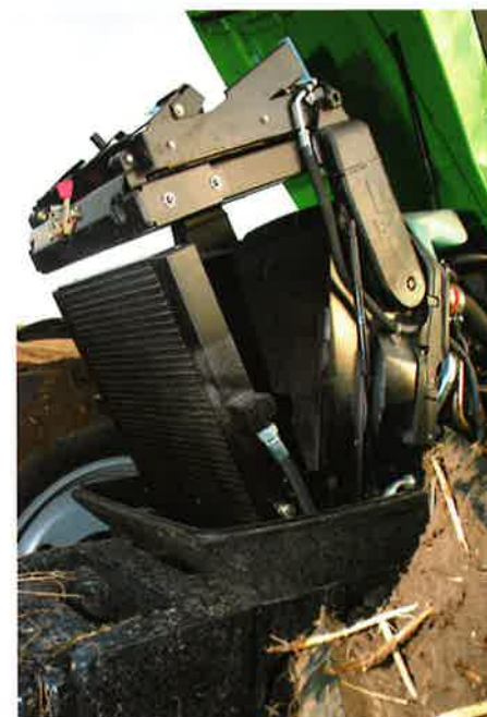
Dernæst klappes hydraulik-, gearkasse- og brændstofdøler ud, så det er nemt at rengøre alle elementerne.
