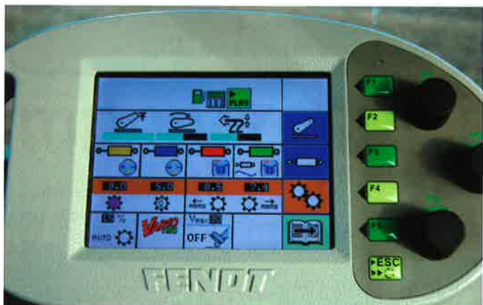
Varioterminalen rummer et hav af muligheder, hvor man kan indstille stort set alle funktioner i terminalen. Det giver en dejlig ro og overskuelighed, at funktionerne ligger i én computer i stedet for mange kontakter og displays i kabinen.
