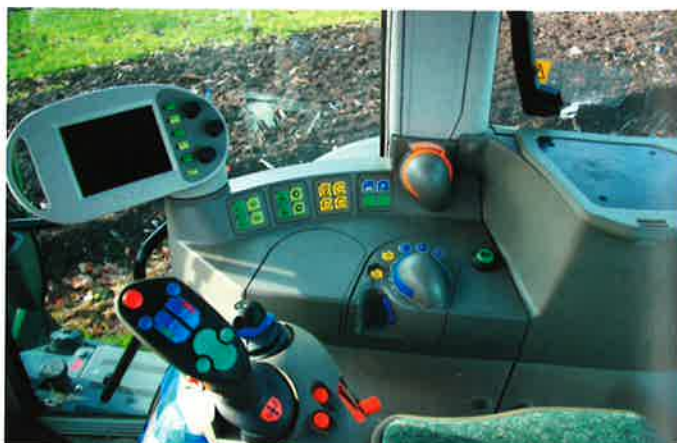
Man kan styre både lift, olieudtag, foragerautomatik og fremkørselshastigheden i joysticket på højre armlænskonsol. De mange knapper får man relativt hurtigt overblikket over.
