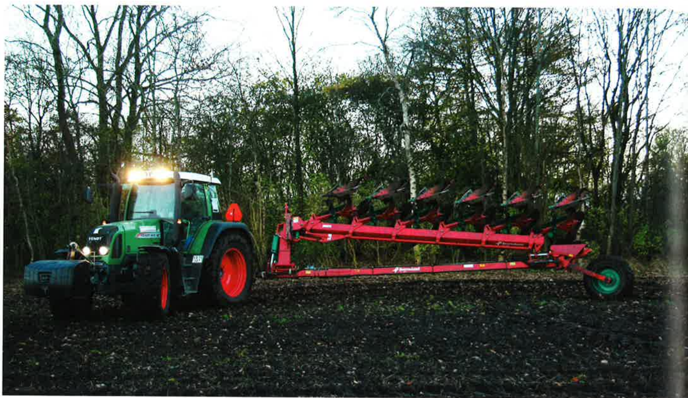
Fendt 415 yder 155 hestekræfter på fire cylindre. Under prøveførslen trak den fint af sted med den seksfurede kverneland-plov.
