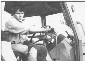
Håndtaget til håndgassen er anbragt for langt fremme - det ville være langt bedre, hvis det blev rykket længere tilbage.
