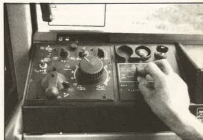
Lift og differentialsperre betjenes fra denne pul i førerkabinen. Pulen er veludstyret med funktioner, der rækker ud over de basale behov. Ud over løftensens-funktionen kan fem funktioner betjenes fra pulen - nemlig max. løftehøjde, særk-hastighed, positions/trækraft-blendingsregulering, millerlig-guldbog af vægtoverføring samt positionshøjde/dybderegulering.
