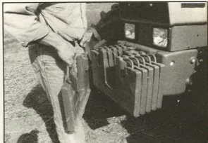
Frontvægtene kan i princippet påbygges i det uendelige - uden brug af værktøj.
