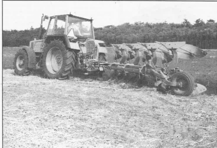
Traktoren blev afprøvet i let kuperet terræn med sandmuldet jord. Testtrakoren er udstyret med en 4-furet Kverneland vendeplov, hvilken ikke er en for stor opgave for den 100 HK traktor.
