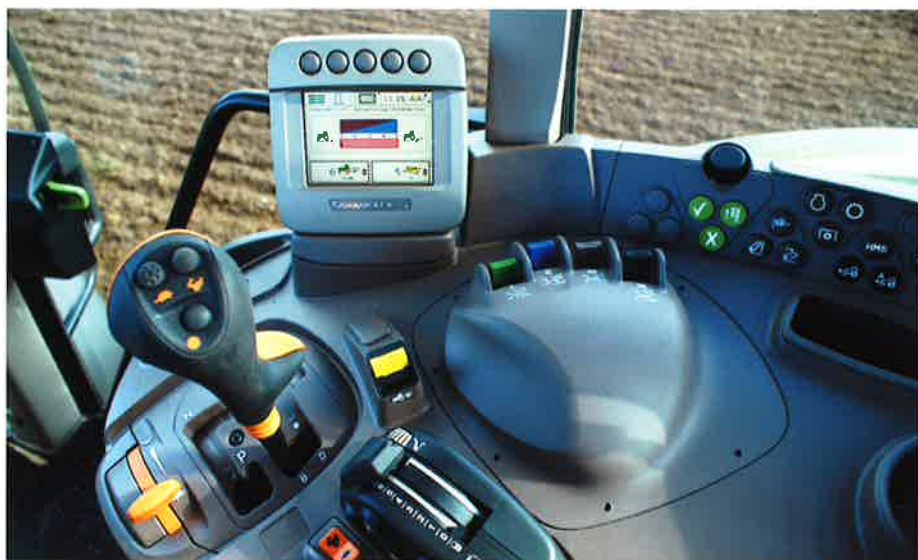
Fra CommandCenter styres og kontrolleres stort set samtlige funktioner på traktoren lige fra transmissionen over liften, de hydrauliske fjernudtag, kraftudtaget, foragerautomatik og til lyset på traktoren.
