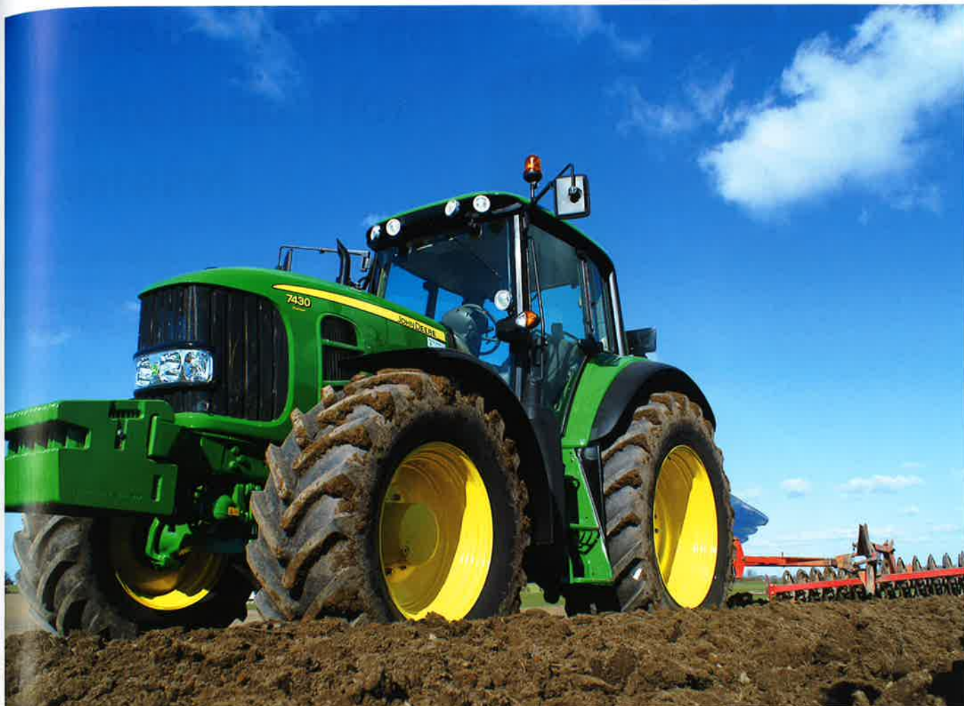
John Deere 7430 bygges i Mannheim i Tyskland, og på mange måder minder den om traktorerne i 6030 serien, men med både større motor og specielt kraftigere bagaksel og lift lukker den sammen med 7530 effektivt hullet imellem de europæiske og amerikanske John Deere modeller
