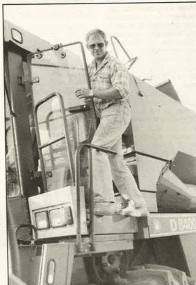
Det er ikke smart at skulle se sig som en akrobat for at komme ind i kabinen, når stigen er slået om i vej-kørestilling. Det er ikke en ellers fornem kabine helt værdigt.
