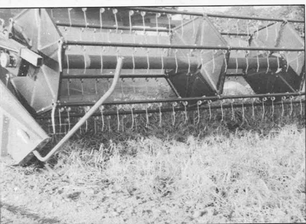
Powerflow bordet har en eminent opsamlingsvne, der styrkes af vindens store bevægelighed. Her er den sønket helt frem og ned, hvilket giver god opsamlingsvne i f.eks. lejesød eller eter. Det er særligt træk ved Dronningborg, at vinden ikke skal placeres i en særlig lejesødsposition, men kan køres helt ned i denne stilling fra kabinen.
