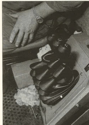
Håndtag til tømmesnegl, tilkobling af cylinder og skærebord, der sidder til venstre for førersædet og fungerer uproblematisk.
