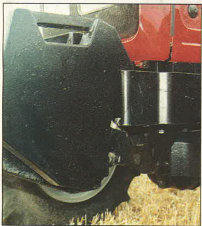
Frontvægtene kan afmonteres uden brug af værktøj
