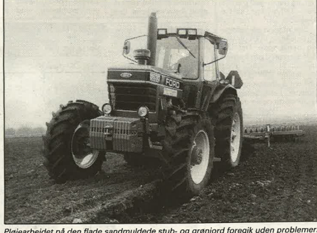
Plojarbejdet på den flade sandmuldede stub- og grønjord foregår uden problemer. Med en 4-furet vendeplow og jordpækker var hastigheden 8 km/t.
