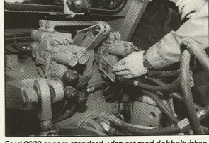
Ford 8630 er som standard udstyret med dobbeltvirkende udtag, der også kan anvendes som enkeltvirkende. Ventilerne er med individuel gennemstrømningskontrol. Flowet indstilles med en fingerskruke.
