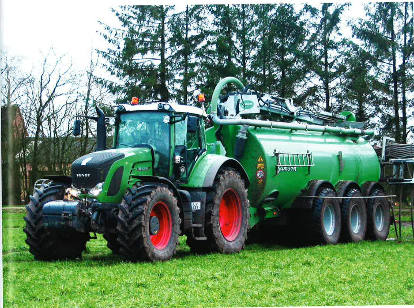
Fendt 936 Vario yder 330 hestekræfter ved nominelle omdrejninger, men den maksimale effekt er på 366 hestekræfter, der alle går fint i spænd med den trinløse transmission.
