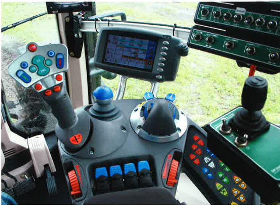
Et blik på højre armkonsol afslører en del knapper. Samtidig kan Vario-terminalen udføre et hav af funktioner, så det gælder om at være kendt med Fendt eller have god tålmodighed til at finde ud af de mange funktioner.
