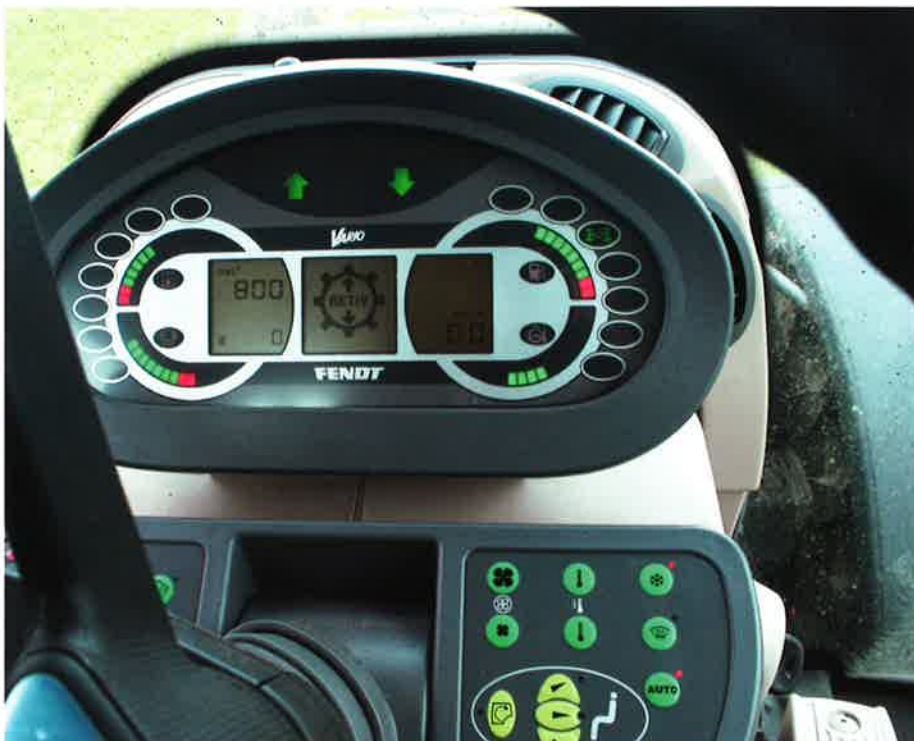
Displayet er digitalt i traktoren. Til højre for ratstammen styrer man klimaanlægget og til venstre aktiveres de forskellige køre- og arbejdslygter.
