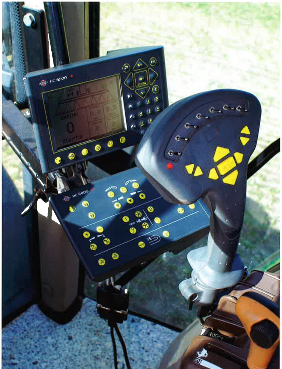
Samtlige funktioner på sprøjten styres fra HC 6500 og fra joysticket, der er monteret på sædets arm-læn. Når vaskeprogrammerne kører, kan føreren på terminalen følge med hvilke opgaver, der udføres, og han har også mulighed for at stoppe programmet for at fylde eventuelt rensmiddel i tanken.
