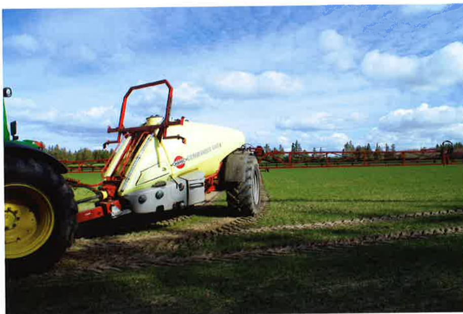
Efter at den ønskede vandmængde er tastet ind i HC 6500, styres den automatiske vandpåfyldning fra FluidBoxen, som er en elektronisk betjeningspanel, der er anbragt på siden af sprøjten.
