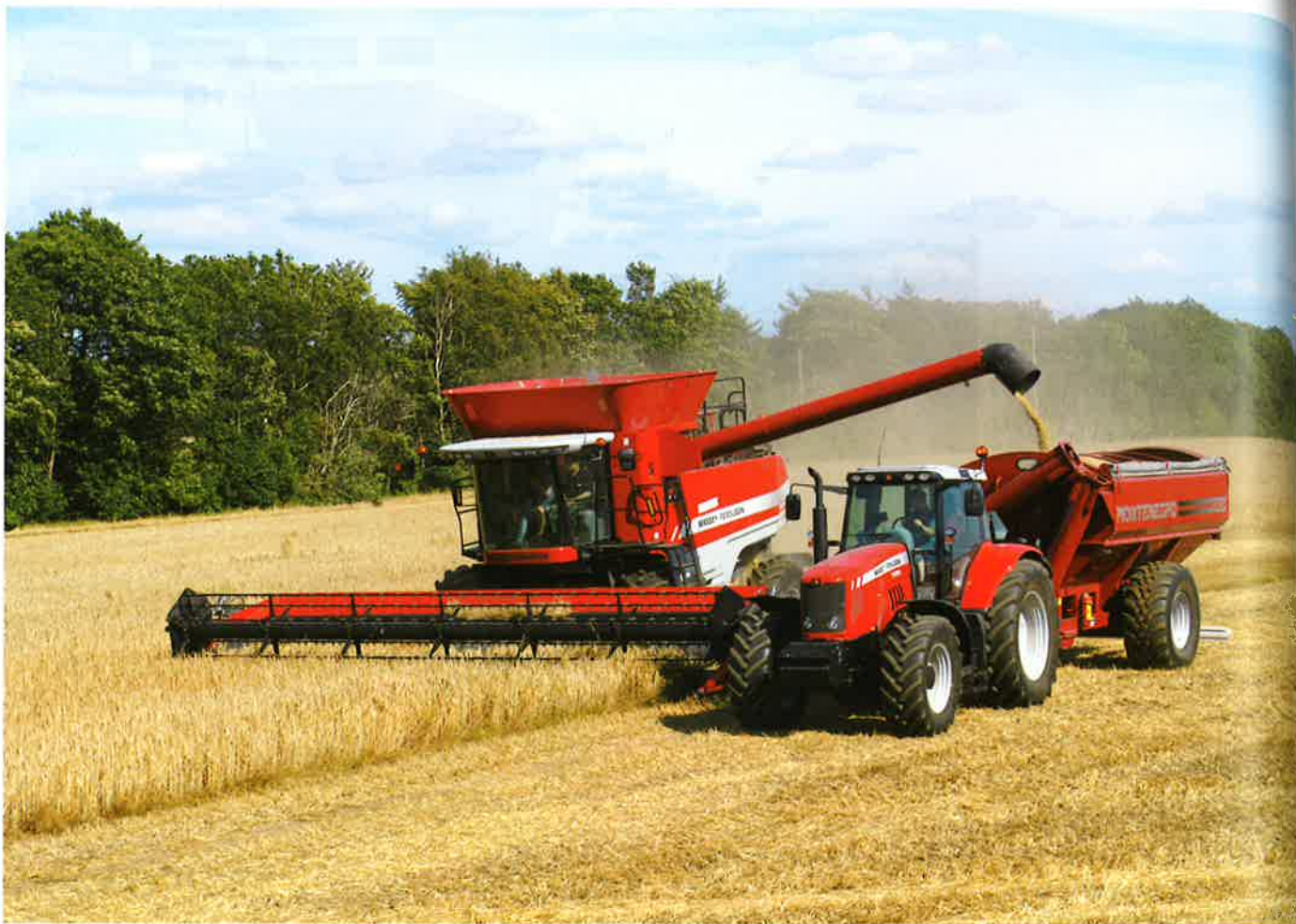
Korntanken rummer 12.300 liter og tømme­sneglen læs­ser af i 4,34 meters højde. I tørt korn har tømme­sneglen en kapacitet på 158 liter pr. sekund.
