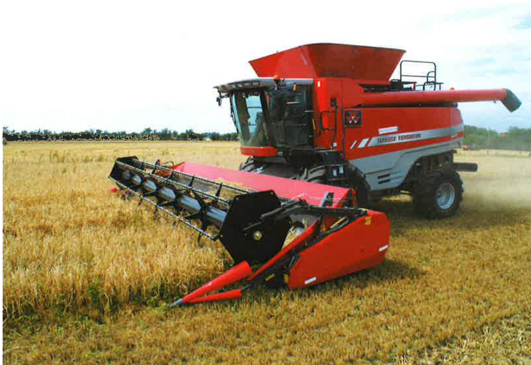
Massey Ferguson 9895 kører med 30 fods PowerFlow skærebord, og tærskningen sker i en rotor med en diameter på 0,8 meter og en længde på 3,55 meter.
