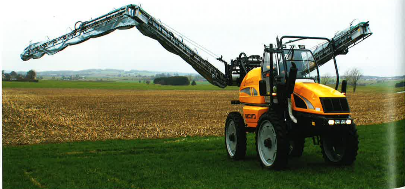
Den 24 meter brede bom på den prøvekørte Mazzotti Ibis 2500 folder kun en enkelt gang samtidig med, at den svinger fremad og lægges i holderen langs førerkabinen.
