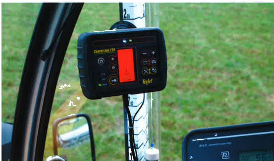
Som ekstraudstyr var den prøvekørte sprøjte udstyret med CenterLine 220 navigationsudstyr, hvor en række lysdioder guider føreren på plads i det rigtige spor. Nedenunder vises det med tal hvor mange centimeter, køretøjet er fra den ønskede position.
