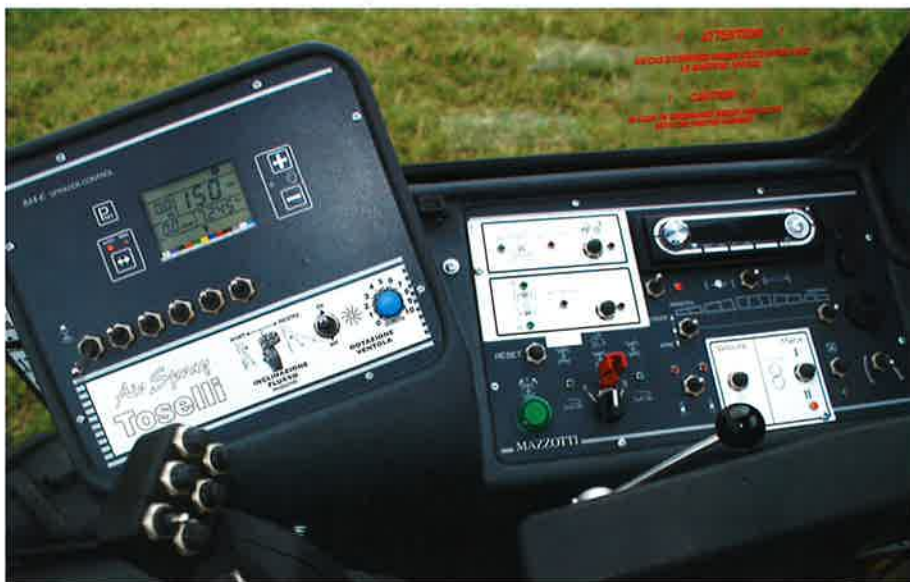
Samtlige funktioner på sprøjten styres enten fra kørehåndtaget eller betjeningspanelet til højre for føreren. Her sidder også sprøjtecomputeren TeeTet 844.
