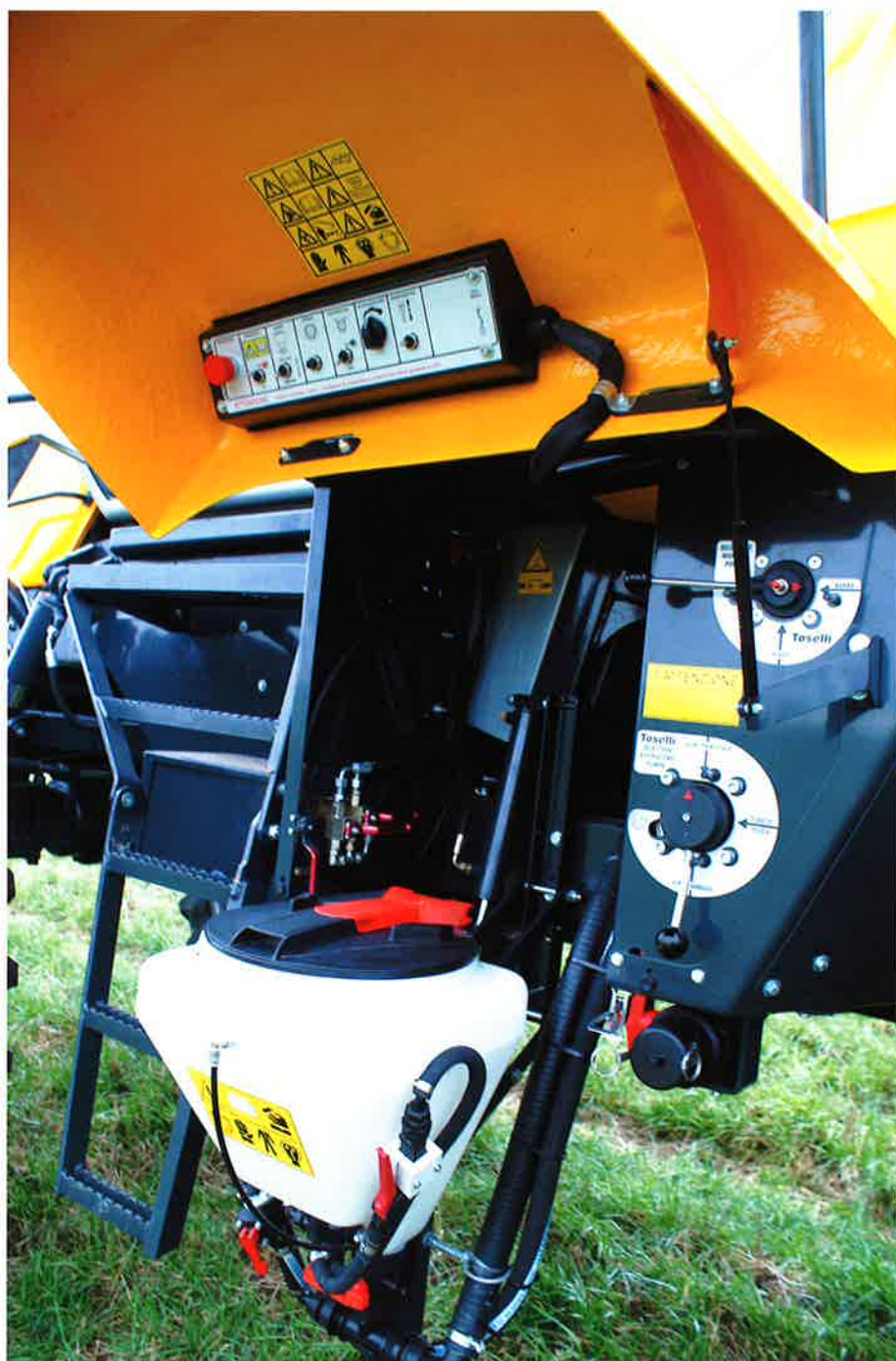
Præparatfylde-udstyret er monteret under en skærm på venstre side af maskinen. Når sprøjten er fyldt, løftes udstyret hydraulisk på plads. På betjeningspanelet ovenover kan de to pumper aktiveres, lige som motoromdrejningerne kan justeres.
