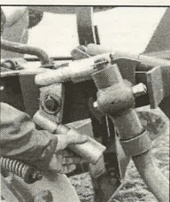
Justering af landhjulet sker ved hjælp af disse to spindler.
