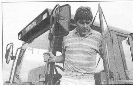
De store sidespejle kan virke generende, når man forlader traktoren
