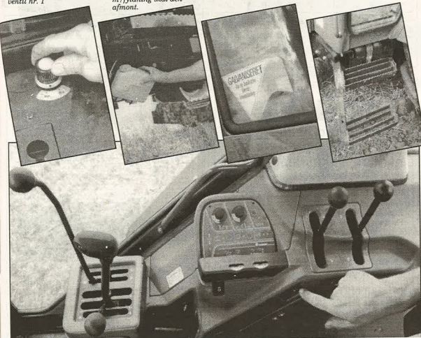
PTO'en indhobles med en vippekontakt på panelet til højre for føreren. Til venstre ses gearstangsarrangementet med hovedgearstangen i midten
