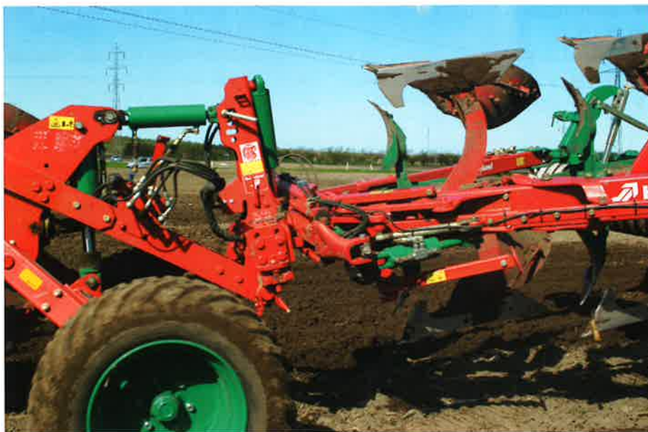
Den bagerste del af PW-ploven består af en helt almindelig EG 200/100 eller LB 200/100 vendeplov, der er monteret i et trepunktsophæng på kærren. Det giver mulighed for at spænde ploven af og benytte den på en anden traktor til eksempelvis at pløje forland på markerne, mens kærredelen pløjer den sidste mark færdig.
