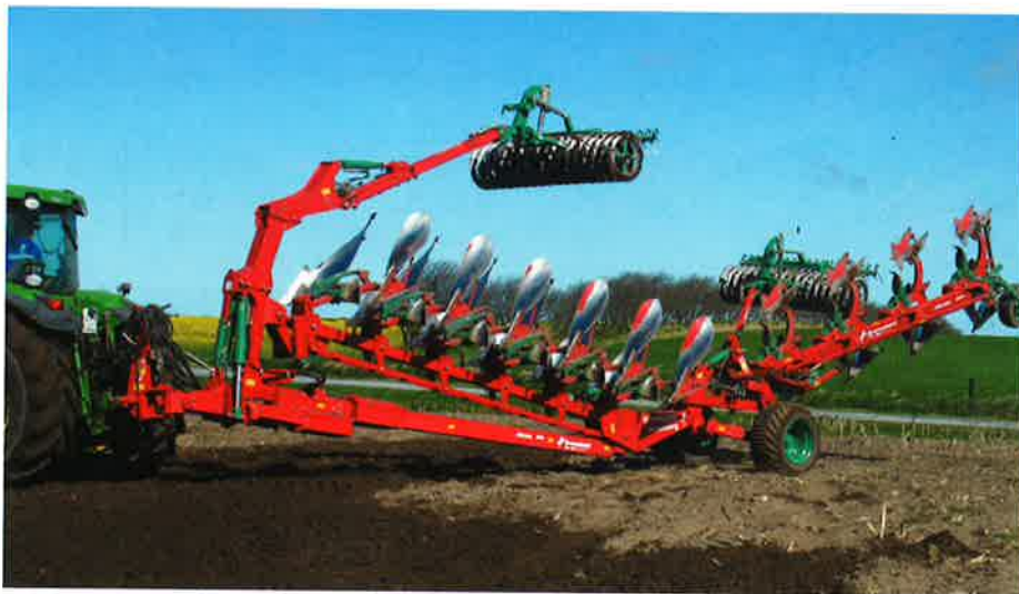
PW 100 fylder i landskabet, men arbejdsbredden er også op til seks meter med ploven. Egenskabene i jorden kan man ikke pege fingre af, men under kørsel på landevejen kan ploven løbe lidt ustabil efter traktoren.
