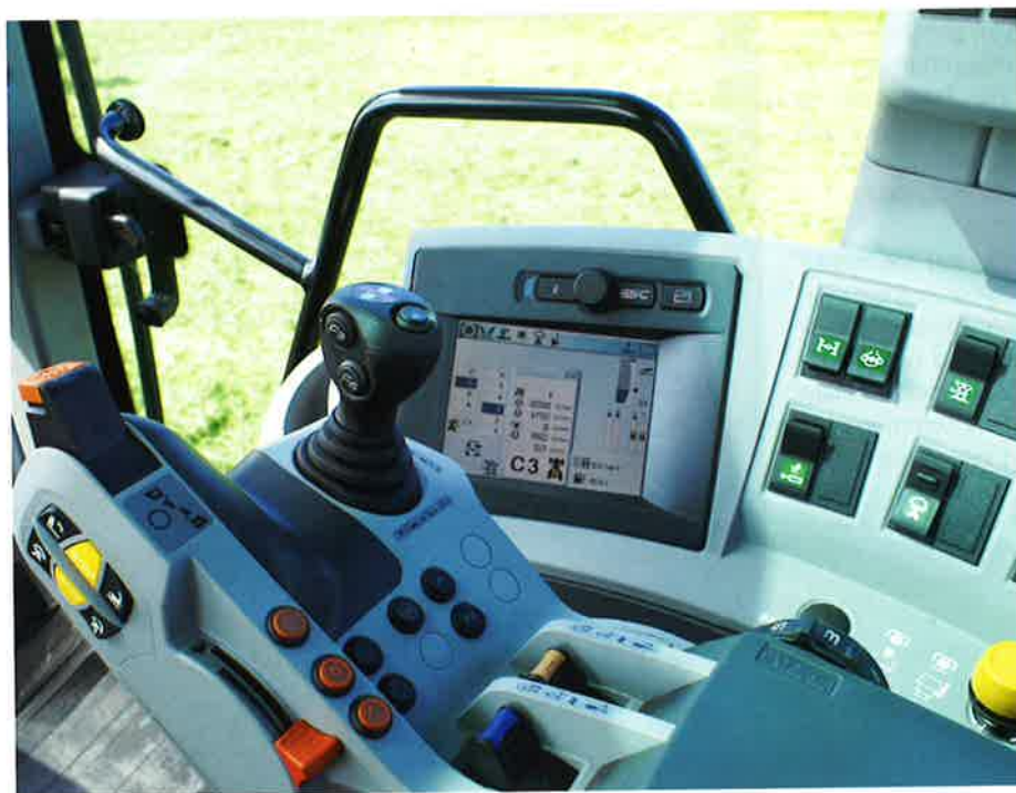
Sædets højre armlæn er omdannet til et kontrolcenter, hvorfra en lang række af traktorens funktioner styres. Drivestick kalder Claas det lille firkantede joystick, der er placeret forrest i armlænet. Det erstatter de traditionelle gearstænger, og herfra kontrollerer føreren transmissionen.
