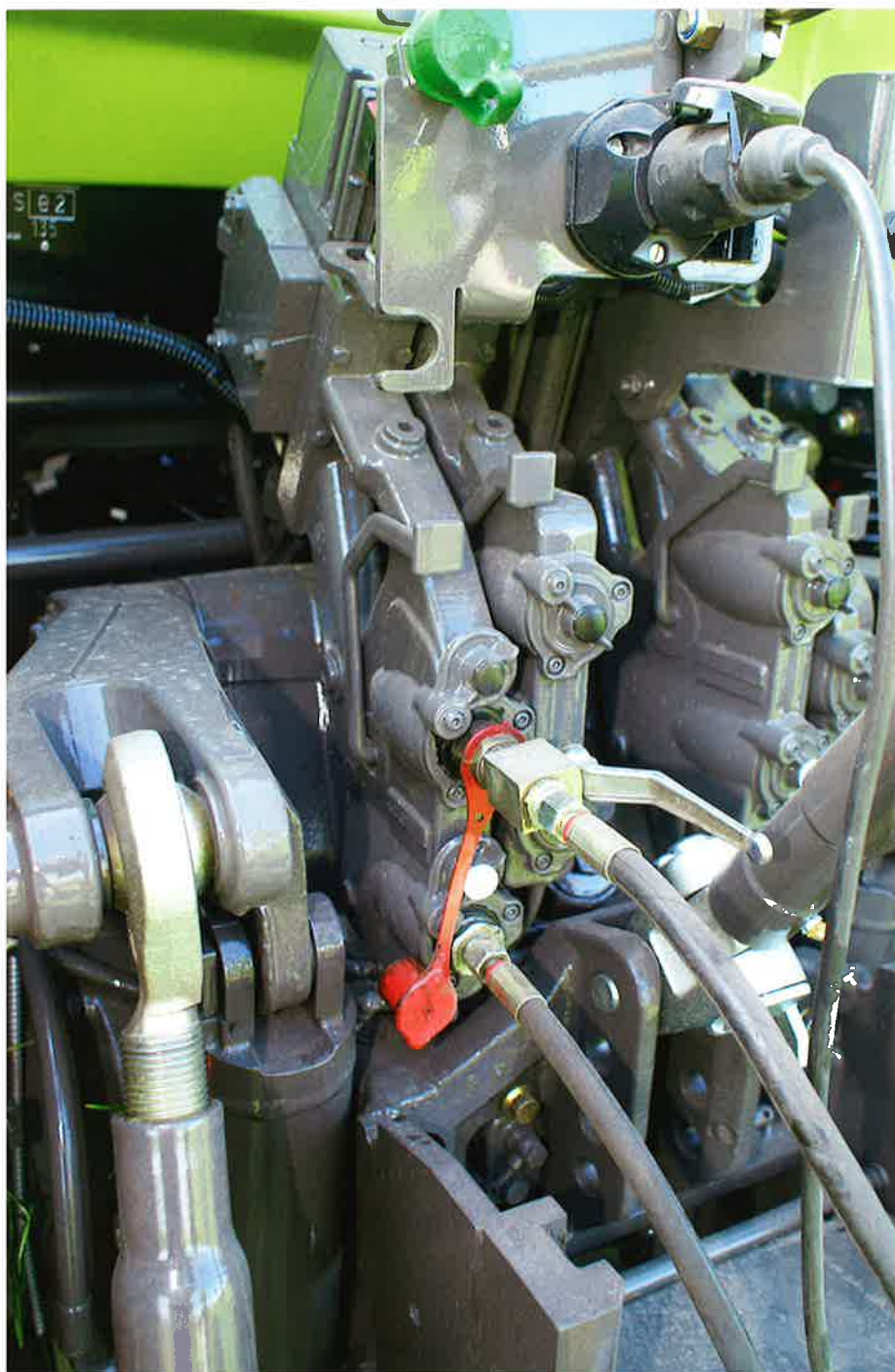
De nye hydraulikventiler giver god plads til såvel standard topstangen som en tykkere hydraulisk topstang. Ventilene er desuden udstyret med et aflastningshåndtag, som gør det muligt at af- og påmontere hydraulikslanger under tryk.
