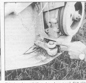
Knivstøjt er let at arbejde med og yde service på. Skift af kniv kræver blot løsning af en enkelt bolt.
