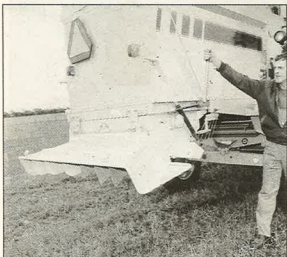
Hulmsnitneren er integreret i halmvæsken og startes/standses fra kabinen. Ledepålen bejgnes med dette håndtag - og det fungerer nemt. En ulempe er dog, at spredplademe skal justeres manuelt efter at der er løstet bolte på selve snitneren.
