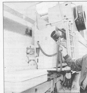
En god detalje: Håndlampe med en ledning, der er tilstrækkelig lang til, at man kan nå hele vejen omkring maskinen.
