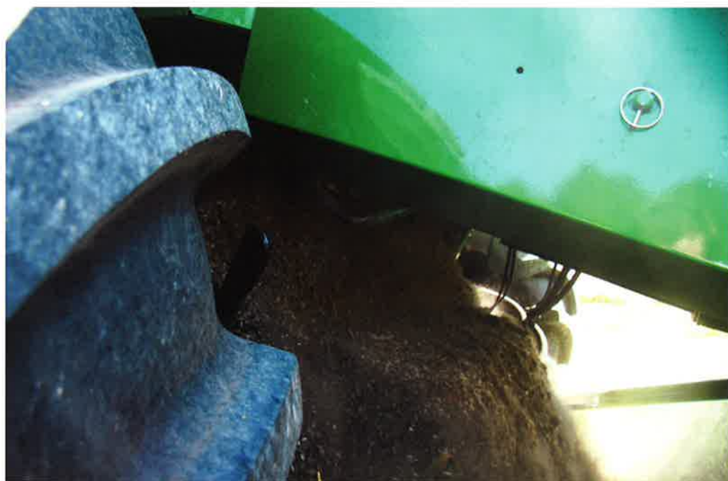
Stenfælden kan ikke aktiveres fra kabinen, som det er tilfældet på nogle andre mærker. Til gengæld åbnes den let via et håndtag ude på siden af maskinen, så man ikke skal ind og kravle under den.
