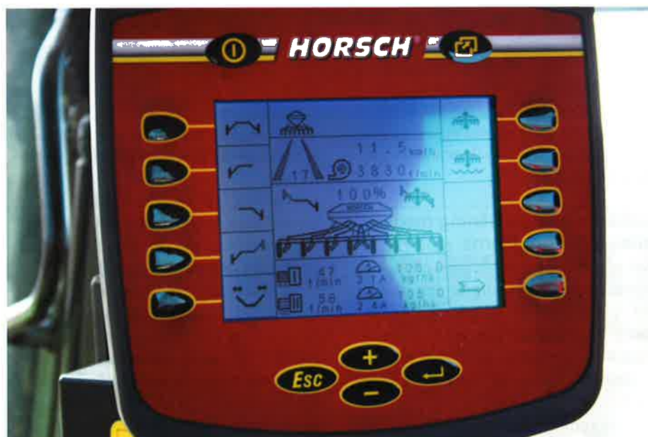
Computeren til såmaskinen. De sorte knapper viser ikke hvilke funktioner, de har, men til gengæld viser displayet dem. Det er også computeren, der styrer indsåningen af maskinen. Man skal blot vælge hvilken af de tre doseringsenheder – korn, gødning eller frø – der skal sås ind.
