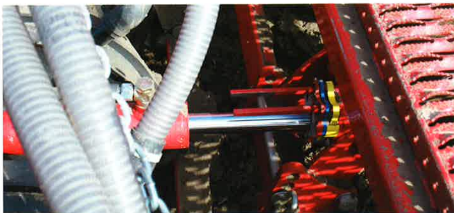
Ved at lægge afstandsstykker ned på selve stemplerne justerer man dybden på de forskellige "arbejdsredskaber" på maskinen.
