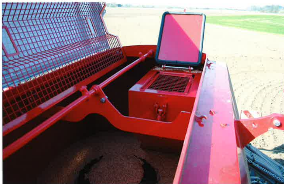
Frøkassen er placeret inde i korntanken. Placeringen er afgjort valgt på grund af designet og hedsindtrykket af såmaskinen. Men ud fra et praktisk synspunkt kan denne placering diskuteres.
