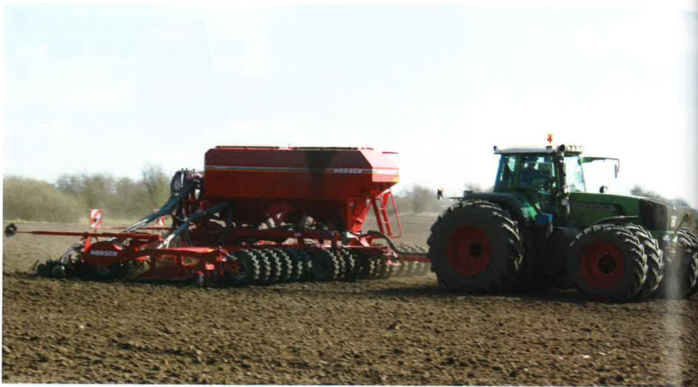
I forhold til de mindre modeller har Pronto 8 DC fået en drejbar pakker forrest på maskinen, der reducerer belastningen på traktoren. Efter pakkevalse kommer to rækker tallerkendiscs efterfulgt af gødnings-skærene. De følges op af endnu en gummipakkevalse før såskærene. Til sidst pakkes jorden igen.
