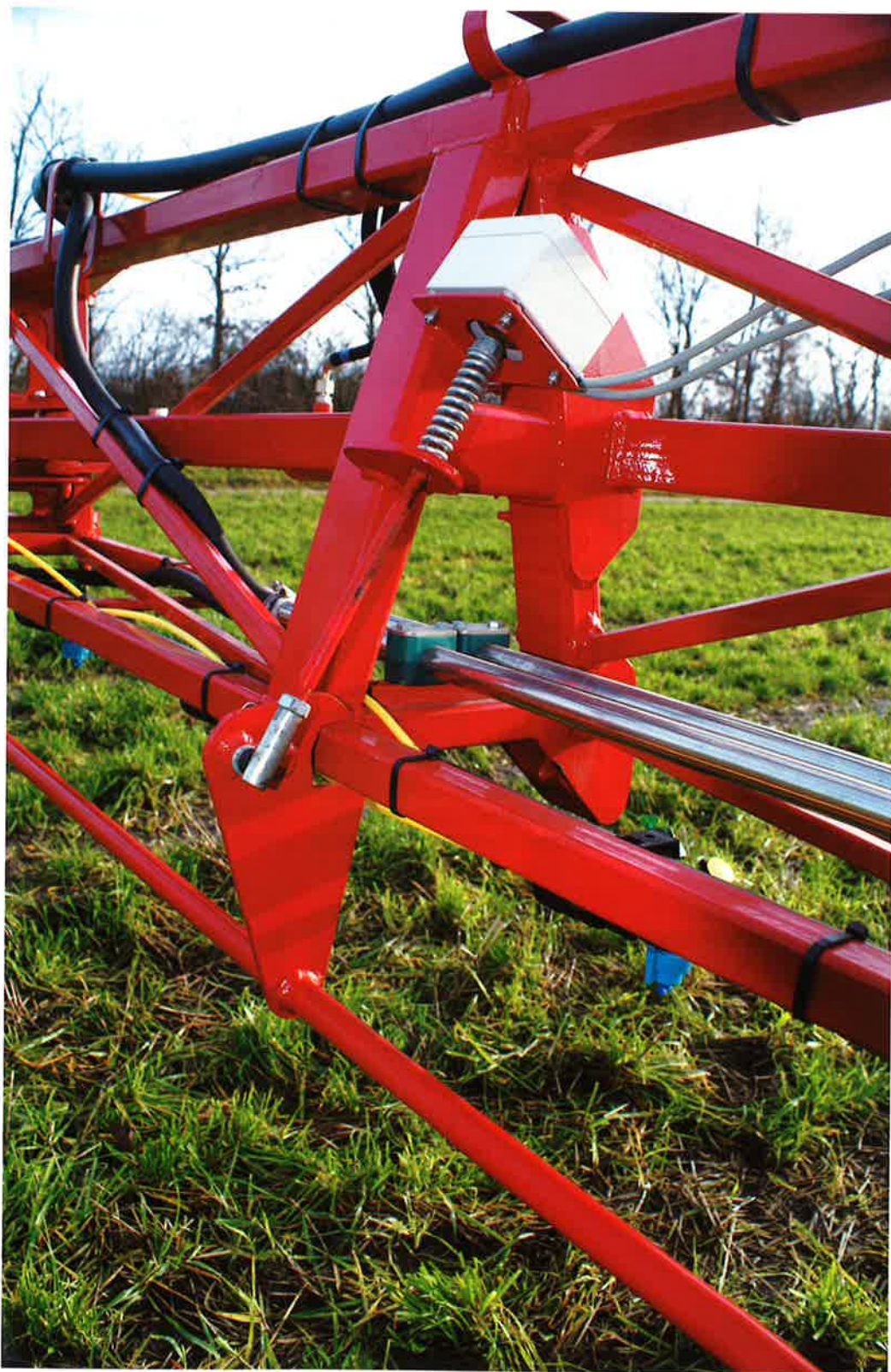
Hvis den brede bom bliver hængende i afgrøden, udløser et sikkerhedssystem det hydrauliske system, og bommen kan svinge bagud.
