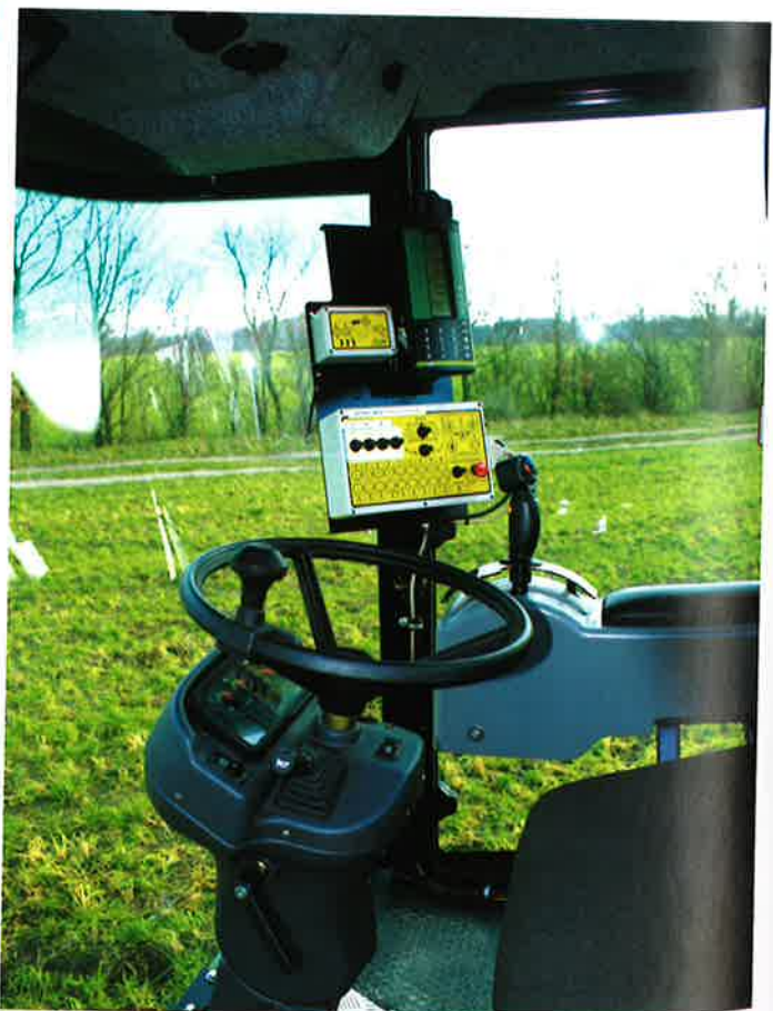
Scan-Sprayer SP3500 anvender en LH 4000 computer til styring af sprøjteopgaverne. På computeren indtastes dysetype og den ønskede væskemængde per hektar, og inden for rimelighedens grænser holder computeren herefter en stabil tildeling uanset hastigheden.
