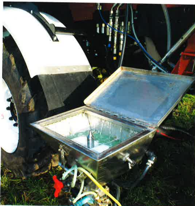
Præparatfyldeudstyret på Scan-Sprayer SP3500 er udført i rustfrit stål, og kan foldes ned til en behagelig arbejds højde.
