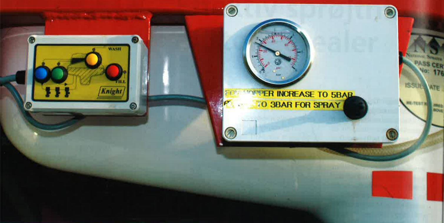
På et panel lige over præparatfyldeudstyret betjenes sprøjtens forskellige ventiler med el-kontakter. Her har sprøjteføreren også mulighed for at justere motoromdrejninger og sprøjtetryk.
