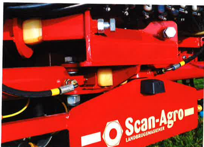
Bommens horisontale bevægelser er dæmpet med et såkaldt Anti-yaw system. Systemet låser bommens to sider sammen, og dæmper det ved hjælp af specielle fiberklodser i bomophænget.
