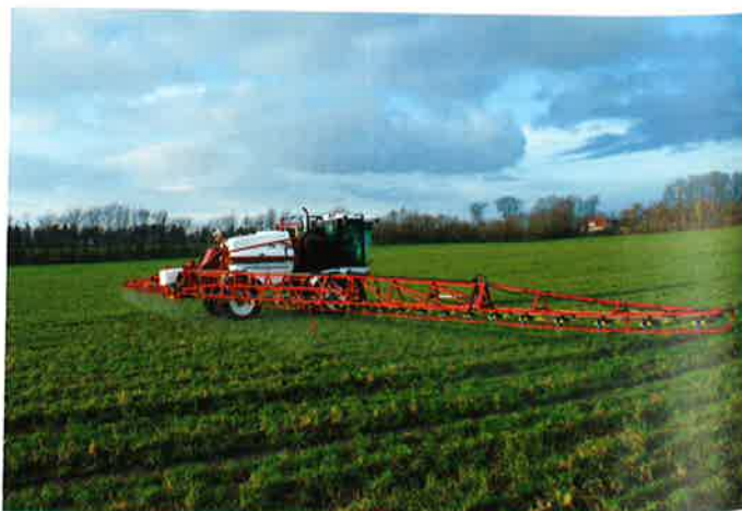
Scan-Sprayer SP3500 kan leveres med sprøjtebomme fra 18 - til 40 meter. Den prøvekørte model var udstyret en bom på 36 meter, der er opdelt på en sådan måde, at den uden videre kan arbejde i plejespor på 12 -, 24-, og 36 meter.
