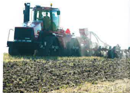
Harven er 7,5 meter bred, og når den arbejder 15 centimeter ned i den fede fynske muld, skal der power til at trække den med over 10 kilometer i timen. Det kan Case IH Quadtrac STX 530, men samtidig konsumerer traktoren også mere end 100 liter diesellole i timen.
