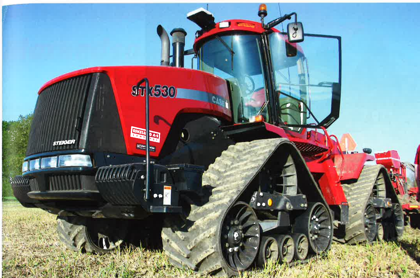
Med en samlet kontaktflade til jorden på 5,576 kvadratmeter overfører de fire bælter effektivt effekten fra den store motor, og under prøvekørslen lykkedes det os ikke at få bælterne til at synke i, ligesom hjulslippet var meget moderat.
