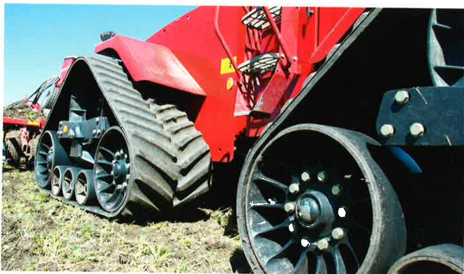
Som standard leveres Case IH Quadtrac på 30 tommer bæltter, men kan også fås med 36 tommer bæltter. Bæltterne har automatisk tilsprængning, og såvel navet som de tre bærehjul er oliesmurte.
