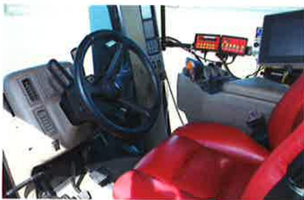
Førersædet er beklædt med rødt læder, og under rattet ses håndtaget til vendegearet, som også indeholder et frigeare samt en parkeringsfunktion. Til højre ses den store ASF 600 Pro touch skærm og betjeningspanelet i sædets højre armlæn.
