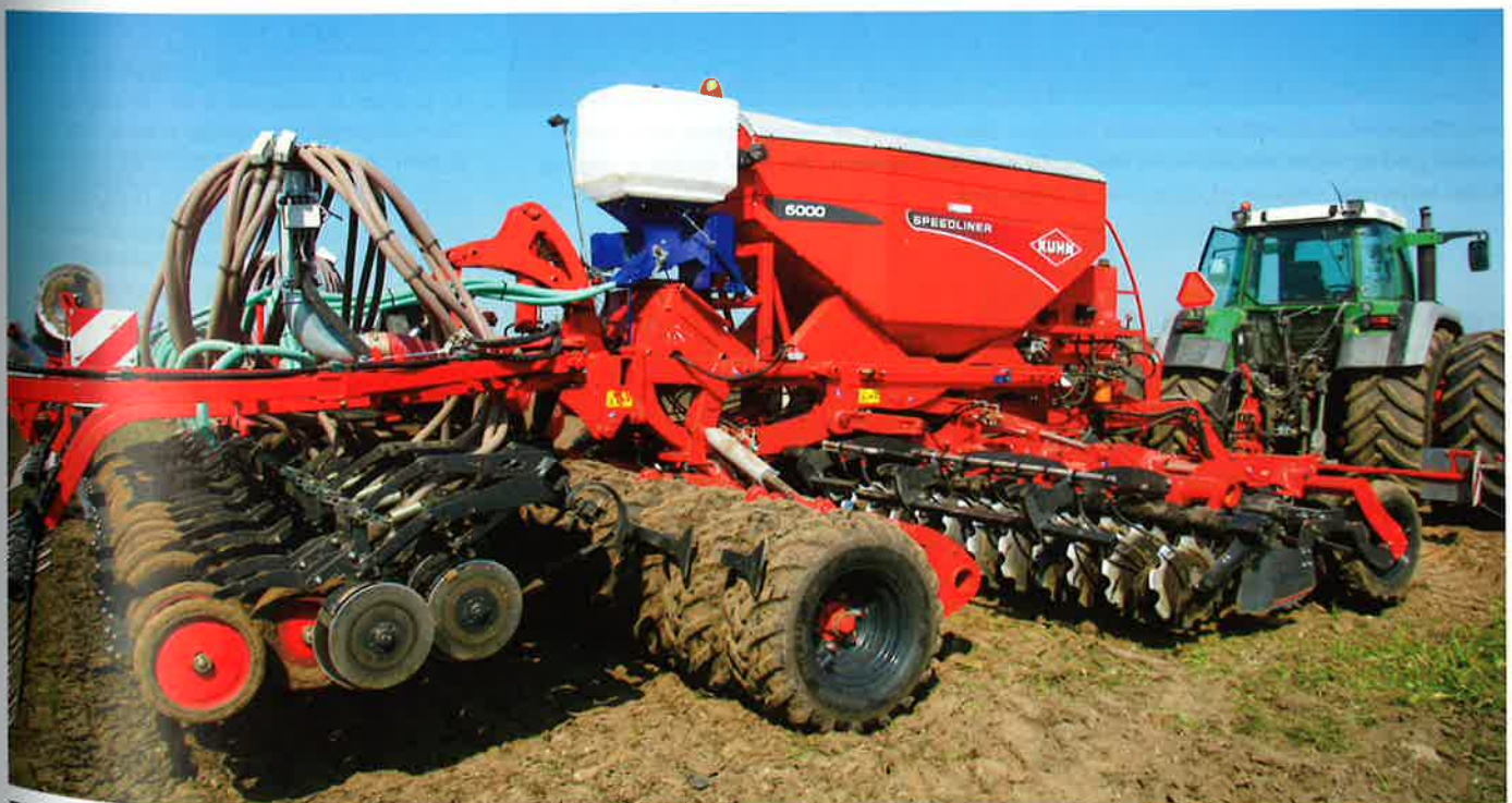
Tanken er på 3.400 liter, og Speedliner 6000 er udstyret med først en række pakkerhjul, dernæst to rækker tallerkendiscs efterfulgt af en stor gummi-pakkevalse. Bagerst sidder så-skærene med trykhjul og efterharve. Såmaskinen lavede under prøvekørslen et rigtig flot stykke arbejde.
