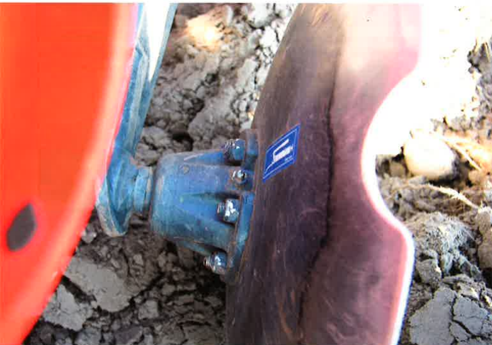
Den nye såmaskine rummer mange af disse. Med 48 tallerkner, 48 så-skær og forskellige led, så nærmer det totale antal smørepipler sig 150 stk.
