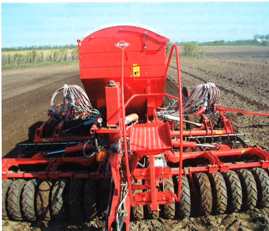
Speedliner 6000 er en helt ny såmaskine fra Kuhn. Den egner sig til såning i pløjet eller stubbe-handlet jord og lukker dermed hullet mellem Fastliner-såmaskinerne, der er til direkte såning, og Kuhns resterende program af såmaskiner til pløjet jord.
