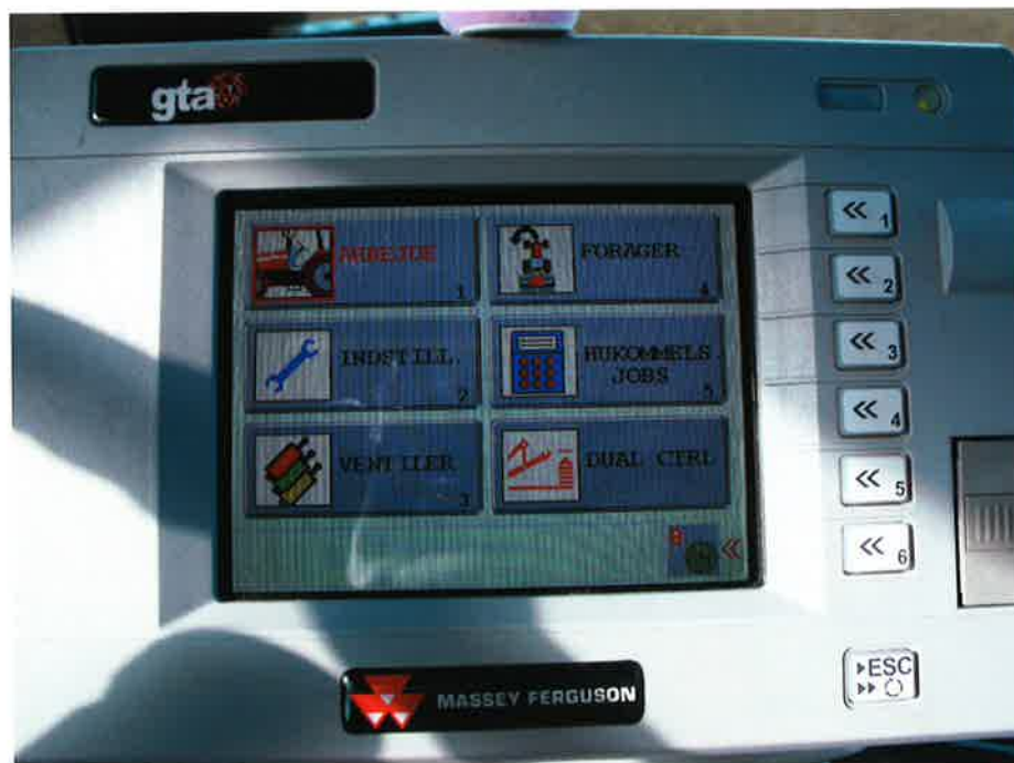
GTA-terminalen er dejlig brugervenlig og er logisk opbygget med seks store menuer. Via drejhjulet længst til højre og de seks knapper manøvrerer man let rundt i funktionerne på terminalen.
