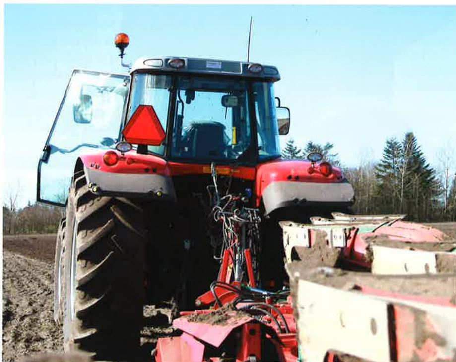
IFTen har en kapacitet på 9.300 kilo. På skærmene kan man betjene både IFTen og pto-udtaget. Hjørnestolperne på kabinen er rykket frem, og det giver rigtig god udsyn bagud fra kabinen.
