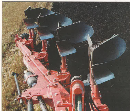
På Grégoire Besson RY 47 kan furebredden indstilles i fem trin fra 12 – 20 tommer.
