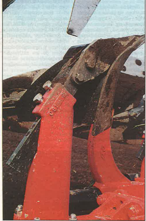
Forpløvene er monteret i et meget kraftigt støbt beslag, hvor de sidder urokkeligt fast. Forpløvene er sikrede mod sten i form af springbolte.
