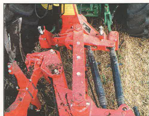
Indstilling af pløvens træklinie og forreste furebredden foregår med to spindler. Bemærk de kraftige gumminchetter som beskytter spindlernes gevind.
