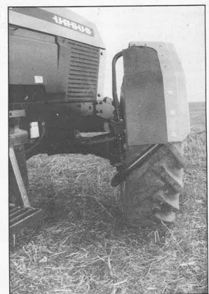
Forsækkelsen holdes af en højle - det er ganske udmærket, men højle går så lang tid, at den kan rage mod jorden, når man pløjer. Man kan i hvert fald ikke pløje for dybt!
