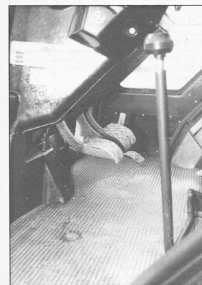
Her er en Ursus nyhed. Pedalerne er nu ophegnede som i en bil - det var de ikke tidligere. Bemærk forrest i billedet den ret generende gearstang.
