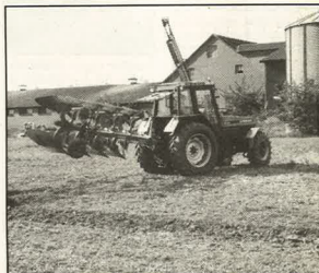
Ursus 1234 blev afprøvet med en Kverneland halmplov i let kuperet terræn. Det var ikke vanskelige forhold, og der kunne holdes en pløjefart på 8 km i timen. I øvrigt passede traktorens krefter - 115 HK - fint til vendeploven.
