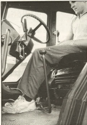
Gearstangerne er store og har en lang vandring. Her ses gruppegearstangen i venstre side af førerhuset. Den er ret generende, når den står i »lav« position, og er også hindrende for de ellers ganske gode indstigningsforhold.
