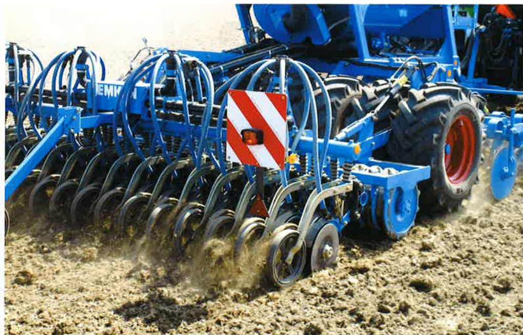
Det nye affjedringssystem består af et kraftigt rør hen over såskærene. Røret er fyldt med olie under tryk, og ud for hvert såskær er der vinkelret på røret monteret en stempelstang med en gummimanchet, som overfører trykket til de enkelte såskær.
