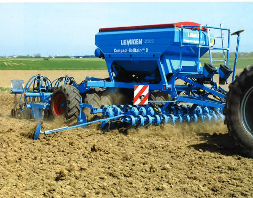
Compact Solitair er en nye såmaskine fra Lemken, som leveres i arbejdsbredder fra tre til seks meter. Som forredskab var den prøvekørte maskine monteret med en lamelslæbeplanke og to rækker tallerkner, der havde god effektivitet på lerknoldene.
