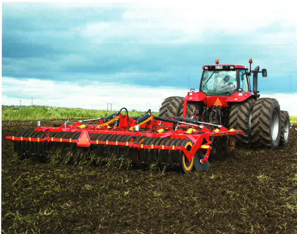
Cultus-harven leverer et pænt resultat efter sig. Man kan styre arbejdsdybden hydraulisk under kørslen, og Cultus kan gå helt ned i 25 centimeters dybde, men så gælder det også om at holde omdrejningerne på traktoren. Cultus 420 kræver op til 290 hestekræfter
