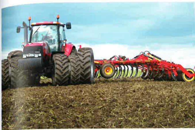
Man kan dreje lige så skarpt, som man vil i forageren, uden at dækkene går på harven. På billedet er pakkevalsen justeret via hydraulikken for at få den bagerste række tænder til at gå tilstrækkelig fri af jorden.
