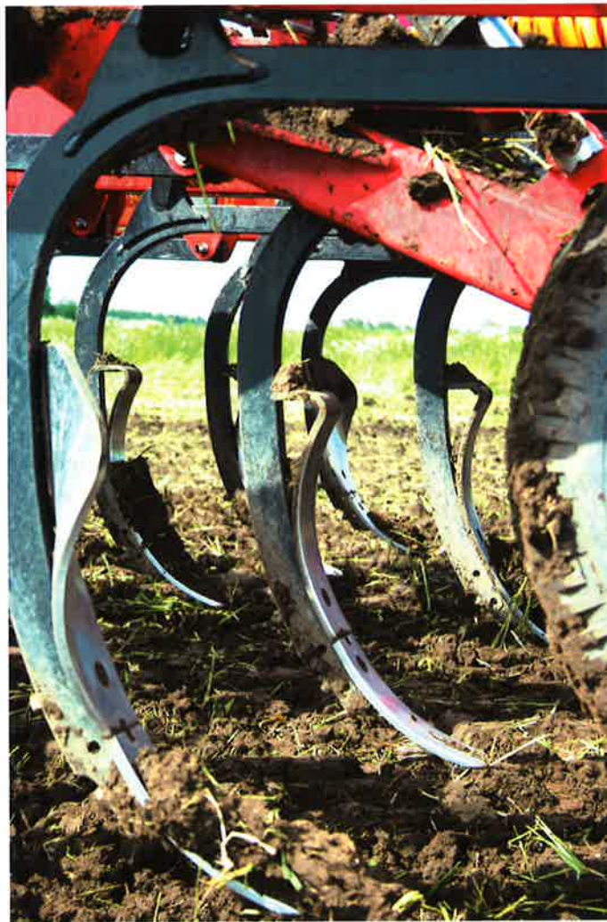
Cultus-harven fås også i en model beregnet til sværere jordtyper. Modellen er i stedet for en gummipakkervalse monteret med en stålvalse og den øverste del af tandskærene er vinklet fremad, så jorden kastes fremover foran tanden. Derved bearbejdes jorden to gange af den samme tand.
