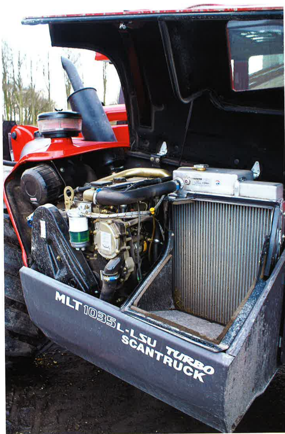
På højre side af maskinen ligger der en 4,4 liters Perkins dieselmotor, der yder 101 hestkræfter. Umiddelbart ved siden af motoren er køleren placeret, og skal læsseren arbejde under meget støvede forhold, kan Manitou levere et udstyr, der automatisk rengør køleren med jævne mellemrum.
