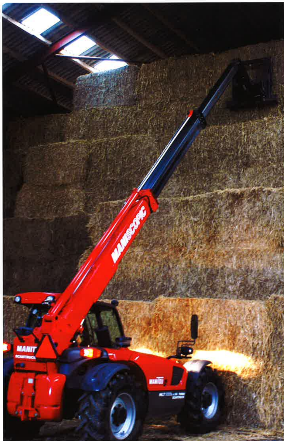
Manitou MLT 1035 LT LSU er en kraftig teleskoplæsser, som løfter 3.500 kg., og som med lethed håndterer to bigballer i næsten 10 meters højde.
