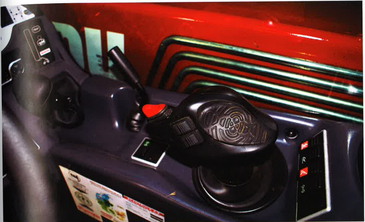
Kørehåndtaget er monteret som en naturlig forlængelse af højre armlæn, og håndtaget ligger naturligt i hånden. Ud over betjening af bom og redskab betjenes også det koblingsfrie vendegear fra håndtaget.
