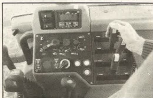
Det elektroniske betjeningspanel til højre for føreren. Nederst: Løftereguleringen. I midten: Præstationsmonitor med et hav af informationer. Øverst: Den elektroniske regulering af motor-omdrejningerne.
