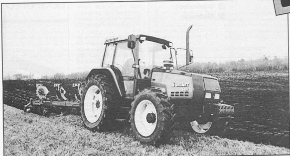
Typisk Valmet design med motoren fremme over forhjulene. Det giver en fin balance med 42 pct. af traktorens vægt på forakslen.
