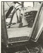
Meget fine ind- og udstigningsforhold i førerhusets venstre side. Læg også mærke til de skriddekrøer trin. Lige under døren ses stikket til den fabriksmonterede motorvarmer.
