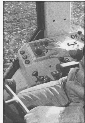
Fra førersædet indstilles og reguleres indstilling af sænkehastighed, max. løftehøjde og blanding af vægtoverføring og positionskontrol.
