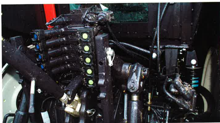
Den prøvekørte traktor var udstyret med fem dobbeltvirkende udtag, som er monteret, så der er plads til en hydraulisk topstang.
