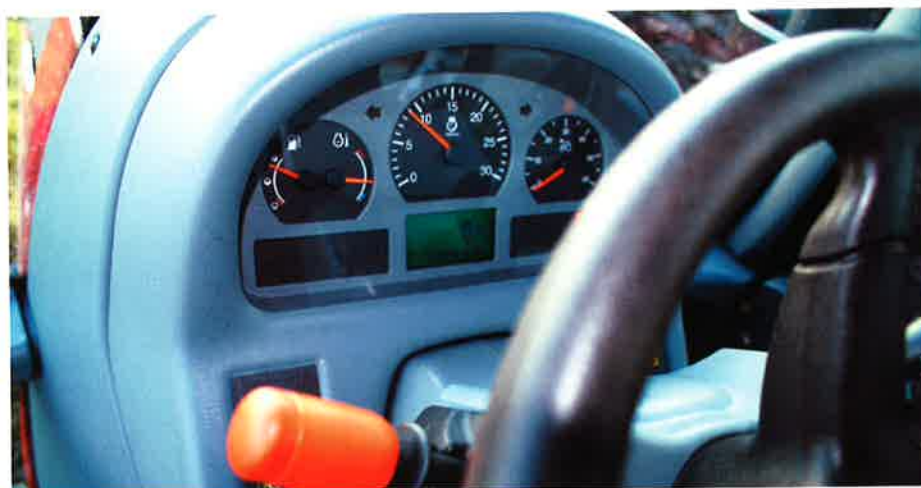
Instrumenteringen er en kombination af analoge instrumenter, der giver det hurtige overblik og digitale instrumenter, der viser detaljerne. Det røde håndtag til vendegearet indeholder også parkeringsbremsen.
