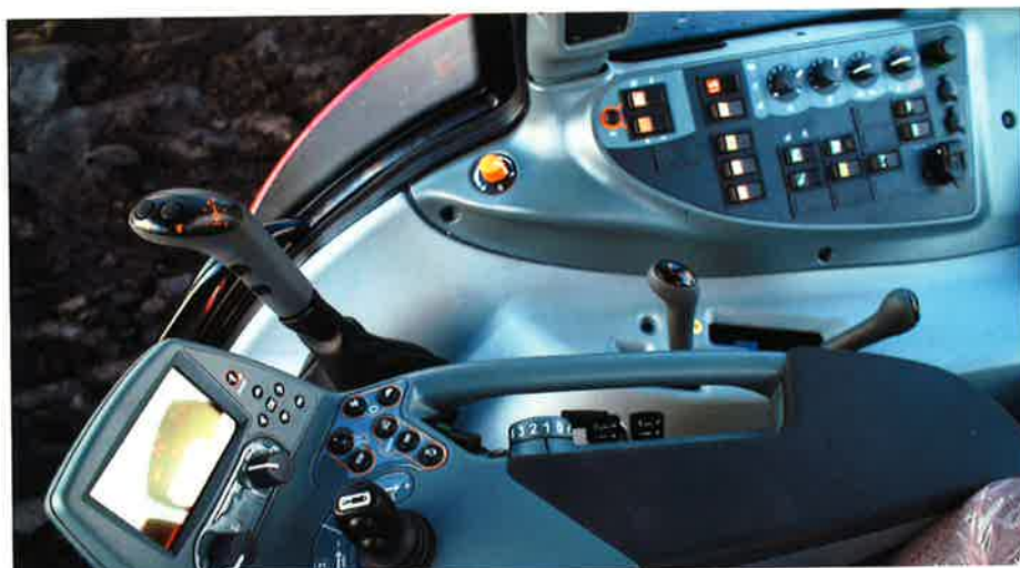
Sædets højre armlæn er ombygget til et betjeningscenter, hvorfra en lang række af traktorens funktioner betjenes. Forrest i armlænet er der integreret et display, der dels anvendes til opsætningen af traktoren, og dels anvendes som informationscenter.
